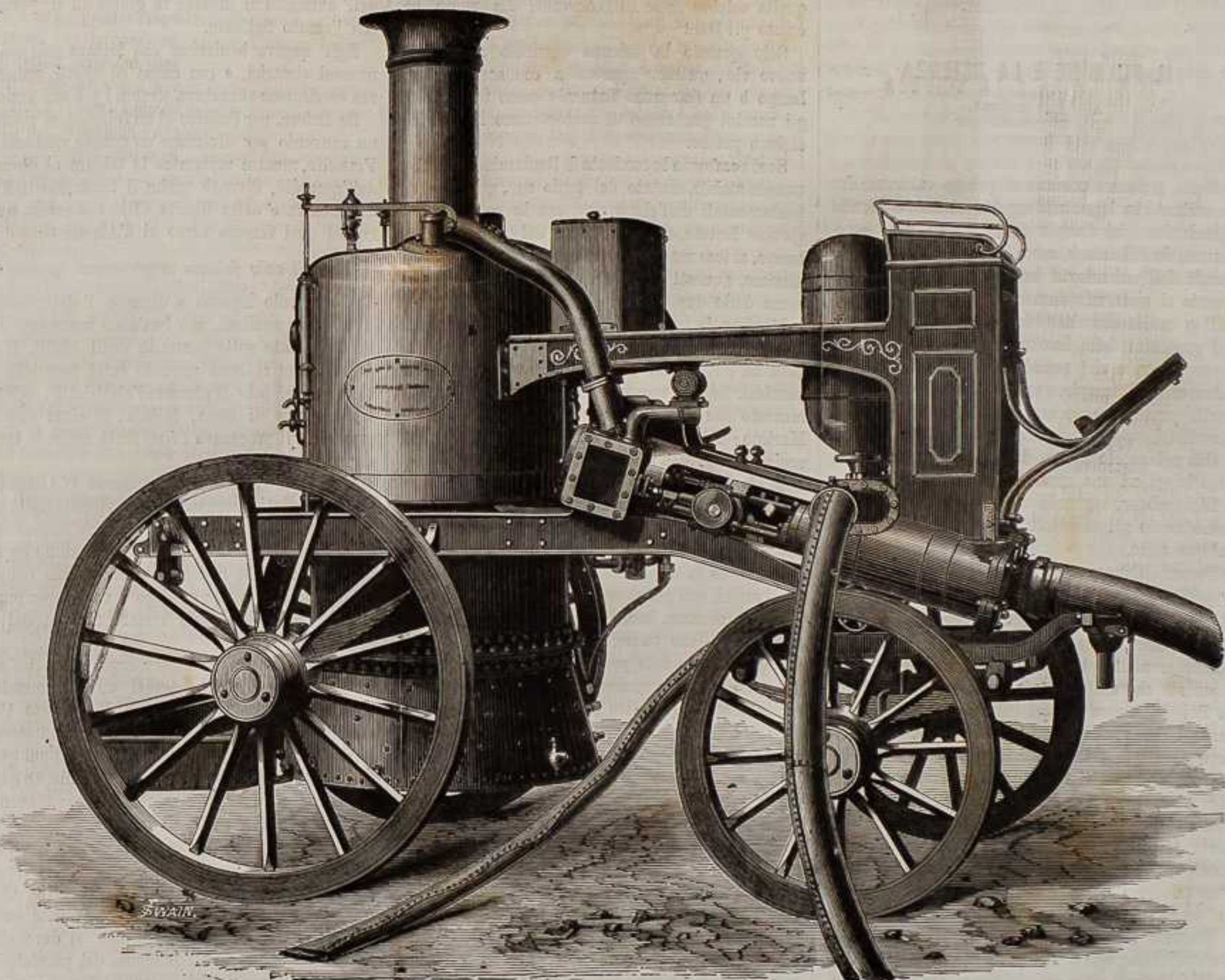
MECCANICA. — POMPA DA INCENDIO INCLINATA, di Shand e Mason ingegneri a Blackfriars.
