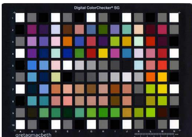
Figura14 - il target Gretag Macbeth ColorChecker SG – 140 tacche formato 8" x 11,5" (circa un foglio A4).
