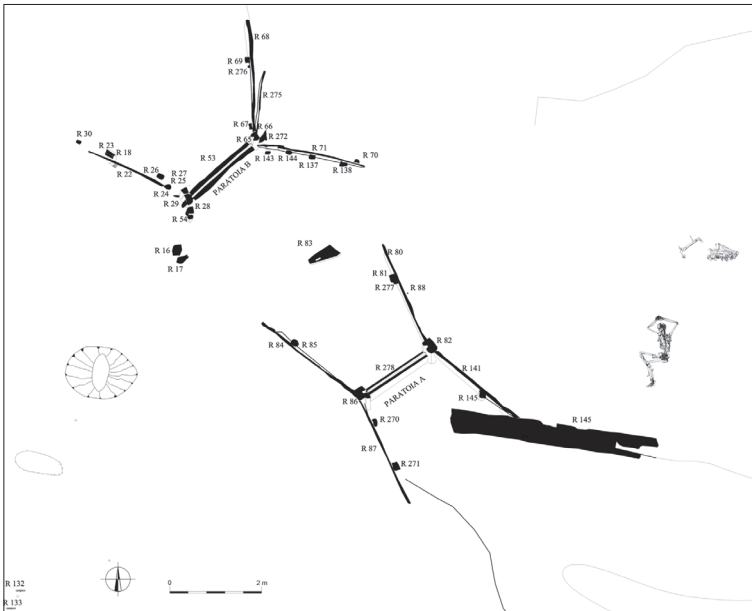
Figura 6 La struttura 2 costituita da due paratoie (A,B) che permettevano di fare entrare l'acqua all'interno delle vasche di decantazione, di cui rimangono alcune assi di contenimento
