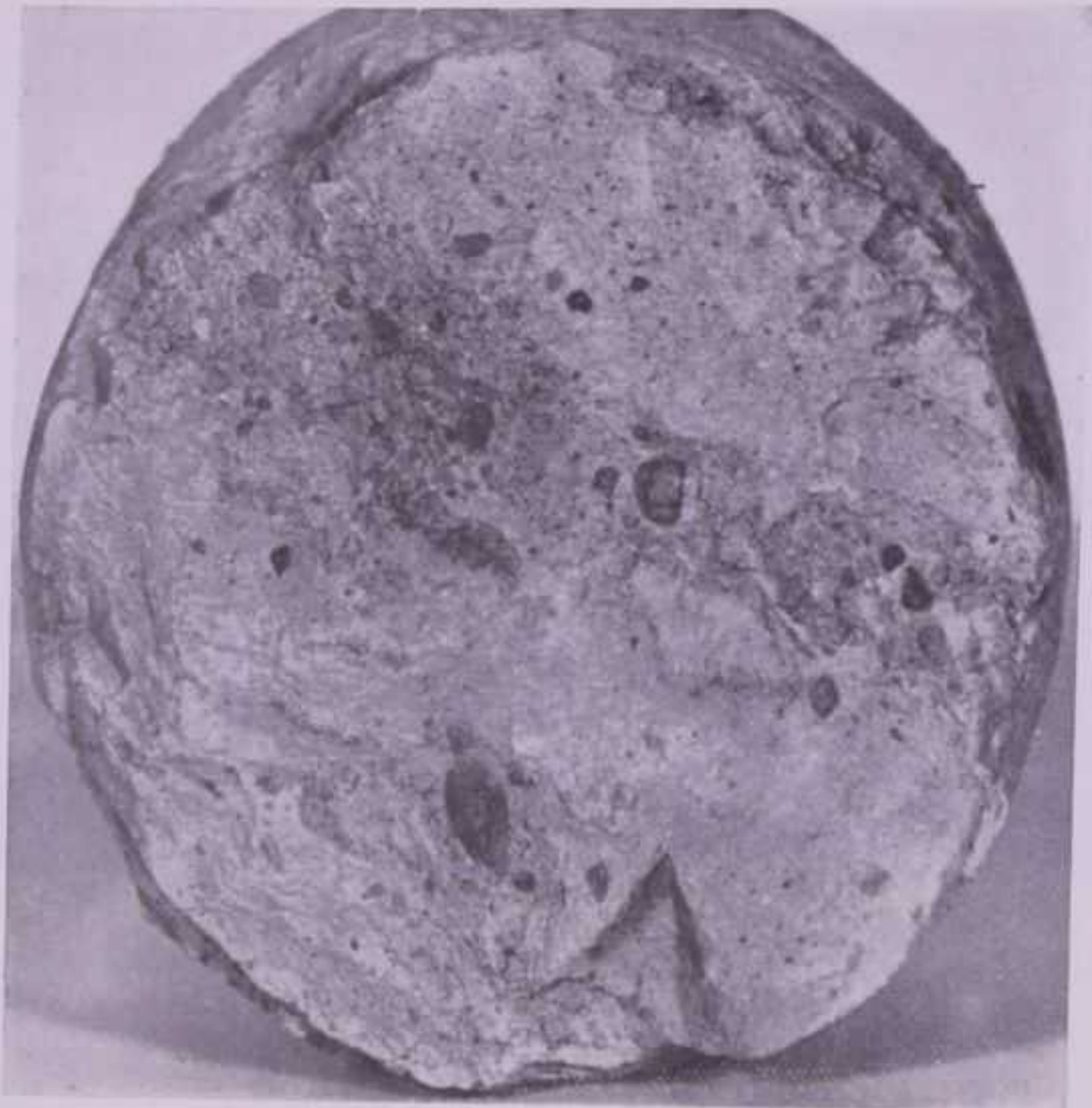
FIG. 19. - Sond. Grottaacalda 5° - Trubi contenenti una brecciolina scura, argilloso-marnosa, delle A. B. IV.
