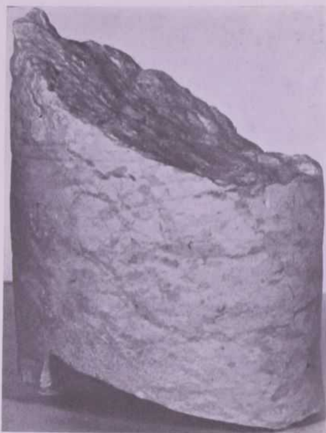
FIG. 34. - Struttura a noduli passanti a brecciolina, di significato moderatamente risedimentario, nei trubi del Sond. Grottacalda 5°.
