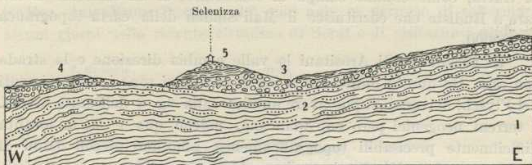
Fig. 1. — Sezione della formazione bituminosa di Selenizza. (Scala: 1 a 20.000 per le lunghezze, 1 a 10.000 per le altezze).
